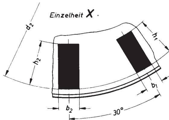
Die rechteckigen Stundenstriche tangieren an den Eckpunkten der Breiten  $b_1$  und  $b_2$  den Durchmesser  $d_2$ .
